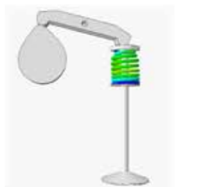
バルブスプリングの高速駆動時の挙動を可視化するコンピューターシミュレーション
