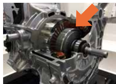
電動車用駆動モーター内で使用される (写真はカットモデル)
