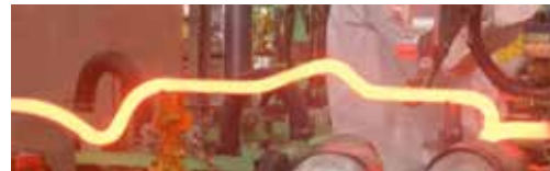
スタビライザの通電加熱【CO 2 排出削減】
