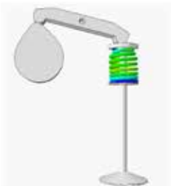
バルブスプリングの高速駆動時の挙動を可視化するコンピューターシミュレーション
