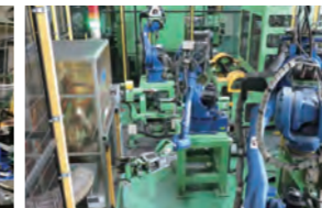
ロボットによる自動搬送や通電式焼熱処理により省人・省エネを実現(懸架ばね事業)
