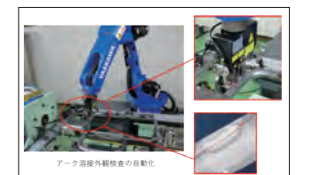
アーク溶接外観検査の自動化
