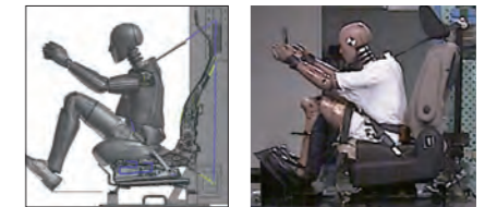
前方衝突 解析画像 前方衝突 実試験写真
