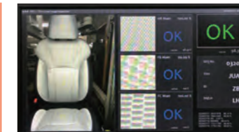
シート外観・形状検査へのAI技術導入による判定作業の自動化と省人化(シート事業)
