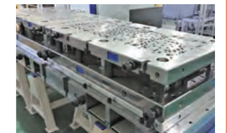
型の高度な設計技術によるプレス加工(精密ばね事業)
